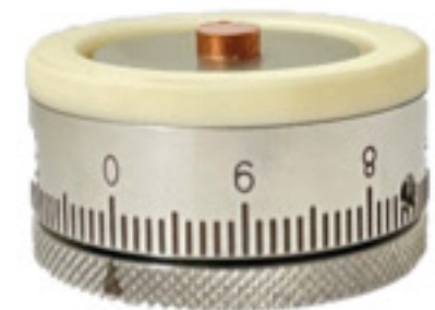
3. 최종 샘플 두께에 맞춰 Stopper를 반시계 방향으로 돌려준 후, 나사를 이용하여 고정 시킨다. (한 바퀴: 1mm)
